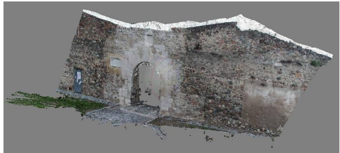
Murallas de Cambrils (Tarragona). Levantamiento fotogramétrico. Nube de puntos.
